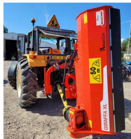
Arrivée du broyeur d'accotement pour l'entretien des abords des routes et des chemins
